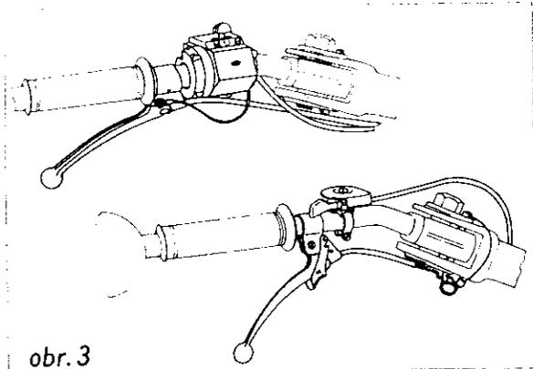
Na páčce je segment se zářezy. Segment aretuje páčku ve stisknuté poloze. Podle intenzity brzdění lze volit vhodný výřez. Odbrzdí se silnějším stiskem páčky brzdy, tím se uvolní segment a je odbrzděno.
