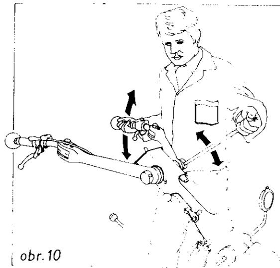
Upozornění - Protože se pomocí klecí řídí malotraktor, je nutná zvýšená péče a kontrola jejich spojení a kloubů.
