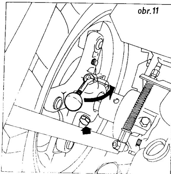
U malotraktoru s kolovým vybavením pneu 5.00-12 lze stupňovitě nastavovat rozchod kol na tyto rozměry: 549, 595 a 695 mm. Změnu rozchodu provedeme tak, že povolíme upevňovací šroub A náboje kola na vnitřní straně kola a nadzvednutím a pootočením páčky B do žlábků odjistíme aretační západku. Nadlehčíme kolo podložením převodovky vhodnou podpěrou. Kývavým pohybem přesuneme kolo do požadované polohy. Zajistíme aretační západku a utáhneme upevňovací šroub.
