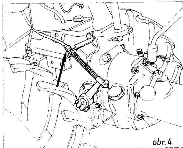
Drzákem bowdenu brzdy prochází průchozí regulační šroub zajištěný maticí. Uvolněním matice můžeme regulovat brzdu otáčením průchozího šroubu. Správně seřízená brzda je tehdy, zaskočí-li aretační segment do prvního zářezu. Do druhého zářezu pak s vynaložením větší síly na páčku.
