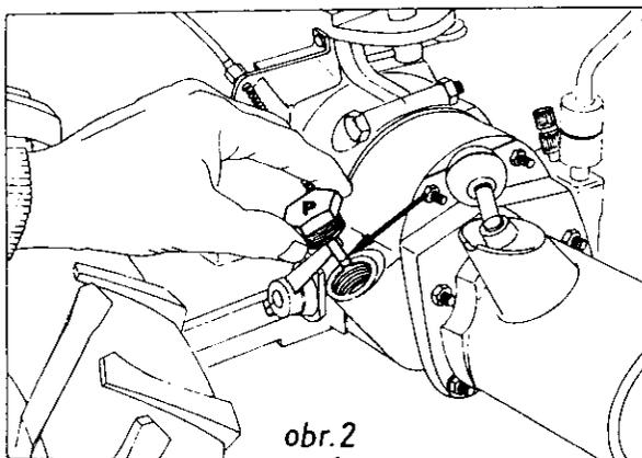
s malotraktorem stav oleje v převodovce a v případě potřeby jej musíme doplnit. Později stačí, když zkontrolujeme stav oleje v převodovce vždy po 10 - 20 pracovních hodinách. Šroubová zátka "P" - obr. 2 - pro plnění převodového oleje opatřena kontrolní tyčkou. Jestliže olej sahá při vodorovně stojící převodovce až ke značce na kontrolní tyčce, je převodovka dostatečně naplněna převodovým olejem.
