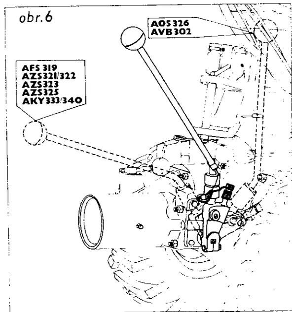
Náhon adaptérů umožňuje vývodový hřídel malotraktoru, který je vyveden do nástavku převodovky. Vývodový hřídel se může otáčet nezávisle na pojezdu a závisle na pojezdu. K řazení způsobu náhonu slouží řadící páka náhonu. Pohyb této páky má tři různé polohy.
