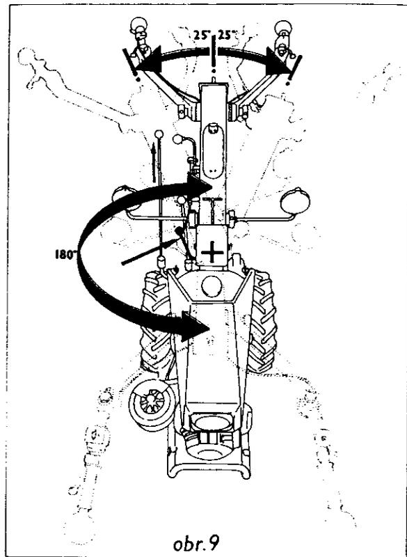
po nadzvednutí páčky - obr. 9 - se do jejího spojení klečů s nosným sloupkem. Potom je nutné vyhodit kleče na každou stranu o  $25^\circ$  a opět zajistit. Dbáme, aby spojovací čep úplně zapadl do příslušného otvoru.
