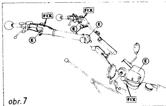
Kleče malotraktoru jsou určeny k jeho ovládání. Jednak k řízení jeho jízdy a dále pro umístění ovládacích pák. Konstrukce klečí umožňuje jejich výškově nastavení ve dvou kloubech dle potřeb obsluhy. Kleče jsou odpružené silentbloky ve třech kloubech a to:
