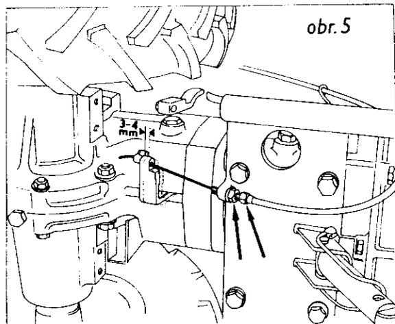
Vůli spojky seřídíme průchozím regulačním šroubem na konci bowdenu ovládání spojky na levém boku skříně spojky. Volný pohyb vypínací páky má být 3 - 4 mm na místě ukotvení.
